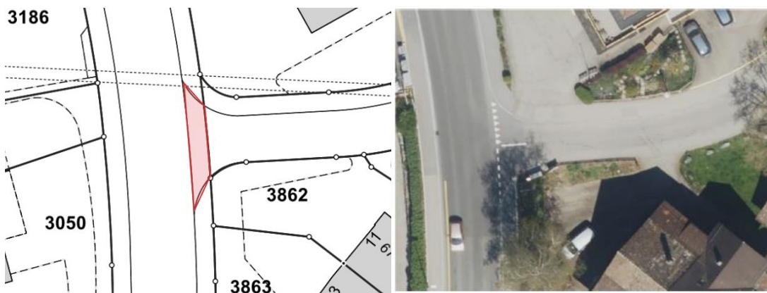
Abbildung 1: Planausschnitt Einmünder mit Trottoirüberfahrt (rot)
