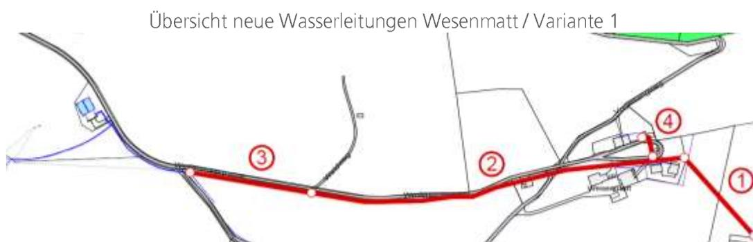
Für den Ersatz der best. Wasserleitung sind PE 180 Rohre eingerechnet. Es steht zur Diskussion, dass Faserzementrohre (FZM), anstelle von PE Rohre, eingesetzt werden. Die Mehrkosten für den Einsatz von FZM Rohren stellen sich folgendermassen zusammen:
