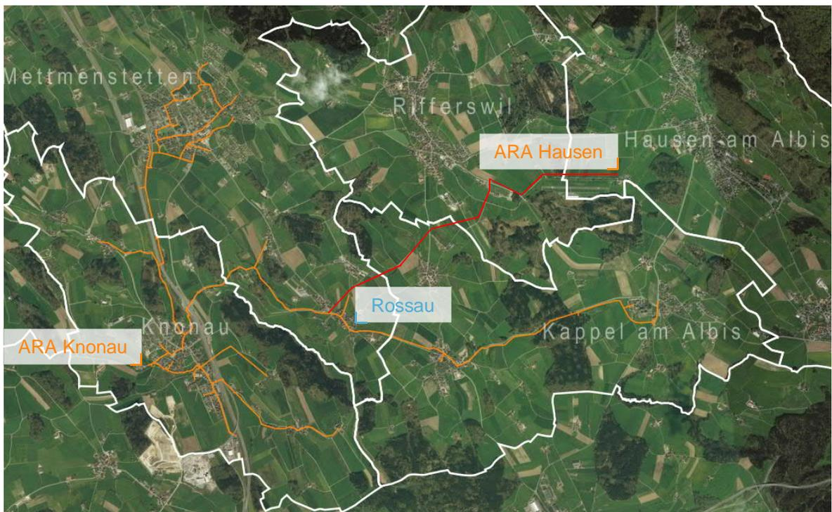
Abbildung 1-1: Übersicht über die Situation. In orange dargestellt ist das schematische Verbandsnetz des AWVK aus dem hydrodynamischen Modell [1]. In rot markiert ist die mögliche Leitungsführung bei einem Anschluss Hausens. Quelle: Bing Arial Maps der Microsoft Corporation ©, mit Anpassungen der Pöry Schweiz AG.
